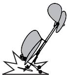
Das Nichtbeachten den Gashebel und die Trimmung bei Propellerberührung oder einem Absturz sofort auf die niedrigste Position zu stellen, könnte den Regler/ Esc in der Empfängereinheit beschädigen und einen Austausch notwendig machen.
